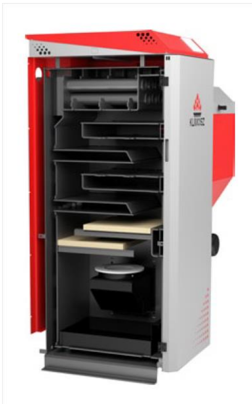
Kocioł retortowy w 5. klasie z poziomymi kanałami przepływu spalin o mocy 20 kW
